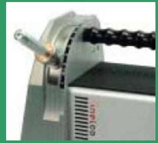
El ángulo del afilado desde 7.5-90° crea un ángulo preciso de los electrodos de 15-180°
